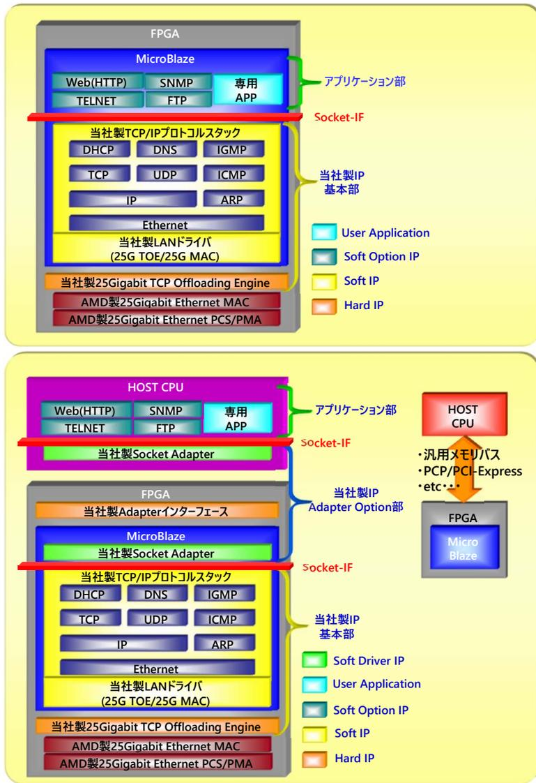
▶ MicroBlazeソフトプロセッサ上に、OKIアイディエス製TCP/IPフルスタックと大容量高速TCP伝送を実現するための25G TOE(25Gigabit TCP Off Loading Engine) IP制御を行う為の制御ドライバとMAC/PHY制御ドライバを搭載
