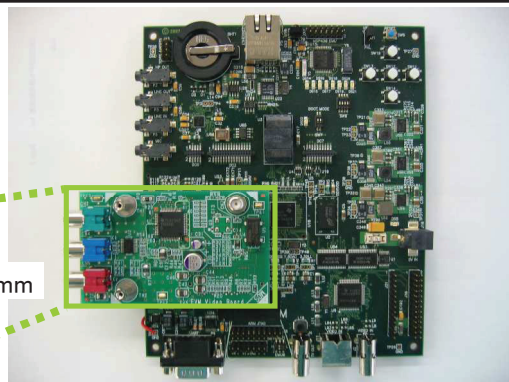
ODIB-DVEVM-THS8200をTI製DVEVM に実装した状態
