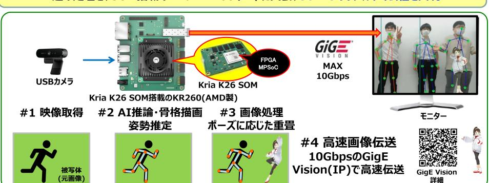
※SOM:プロセッサ コア、通信インターフェイス、メモリ ブロックなど、エンベデッド処理システムの主なコンポーネントを単一ボードに搭載した量産対応可能なプリント回路基板 (PCB) です。
